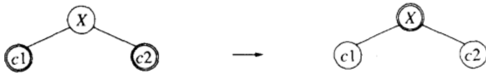
图 12-11 颜色翻转:只有当 X 的父节点是红的时候我们才能继续旋转
